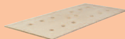
Sommier en panneau de particules épaisseur 19 mm. Ventilation de matelas grâce à 14 trous diam. 64 mm, selon les préconisations du FCBA
