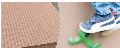
Les planchers, usinés dans des panneaux compact structurés et antidérapants, ont une épaisseur de 12,5 mm.
