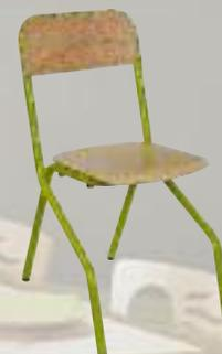
Assise en multiplis de hêtre ép. 8 mm, dossier ép. 6 mm encasté. Tube rond diamètre 25 mm, embouts rentrants en polymère noir non tâchants, non rayants. Empilable par 5. Appui sur table.
