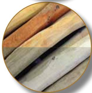
Le robinia est un matériau vivant sur lequel le temps va laisser son empreinte. Le rayonnement ultraviolet et l'oxydation vont conduire à un vieillissement naturel et en surface du bois. Sa teinte va évoluer et se patinera au fil du temps.
