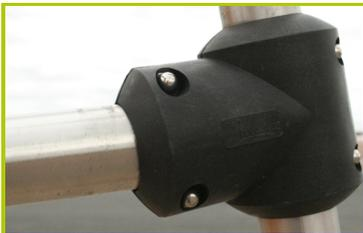
4- **Les pièces de jonction** sont moulées en polyamide chargé, non toxiques, ininflammables, résistantes aux chocs et aux ultraviolets. Elles assurent la robustesse du jeu et la résistance au vandalisme.
