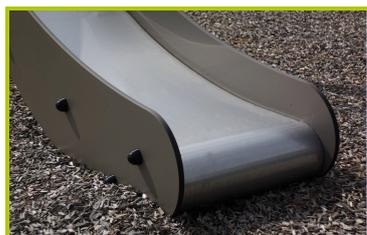
6- **La glissière** est en acier inoxydable de 2 mm d'épaisseur, cintré, plié et roulé d'une même pièce.
