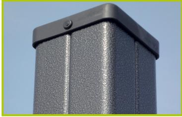
1- **Les poteaux carrés 95 x 95 mm** sont en acier galvanisé peint, garantissant la longévité et la robustesse dans le temps. Ils sont recouverts d'un chapeau en polyamide chargé qui est riveté sur le poteau.
