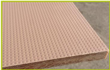
3- **Les planchers** sont usinés dans des panneaux compact (HPL) structurés et antidérapants, d'une épaisseur de 12,5 mm.
