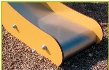
5- **La glissière** est en acier inoxydable de 2 mm d'épaisseur, cintré, plié et roulé d'une même pièce.
