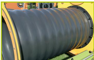
5- **Le tunnel** est en polyéthylène rotomoulé, diamètre 45 cm.
