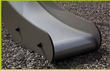
7- **La glissière** est en acier inoxydable de 2 mm d'épaisseur, cintré, plié et roulé d'une même pièce.
