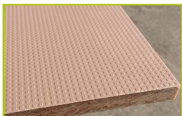
4- **Les planchers** sont usinés dans des panneaux compact (HPL) structurés et antidérapants, d'une épaisseur de 12,5 mm.
