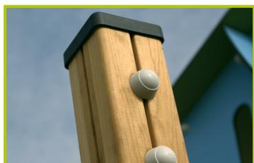
2- **Les poteaux carrés de 95 x 95 mm** sont en pin lamellé-collé traité sans chrome ni arsenic. Exempt d'échardes, le lamellé-collé assure une grande solidité et une stabilité dimensionnelle. Les poteaux sont protégés contre les attaques de champignons et d'insectes. Ils sont recouverts d'un chapeau en polyamide chargé qui est riveté sur le poteau.
