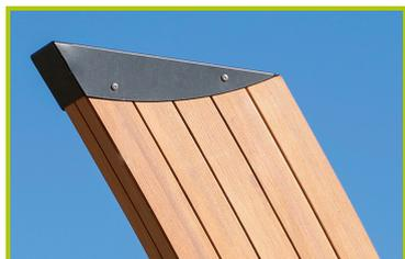
3- **La poutre cintrée** (95 mm d'épaisseur x 200 mm de large x 3,2 m de hauteur) est en lamellé-collé traité autoclave et lasuré. Elle assure une grande solidité à la structure. Son ancrage est réalisé sur fourreaux métalliques.
