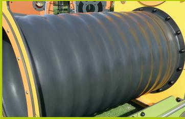
8- **Le tunnel** est en polyéthylène rotomoulé, diamètre 45 cm.
