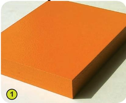
1- **Les plaques laquées** sont élaborées à partir d'un contreplaqué de 21 mm de très haute qualité composé de plis minces en bouleau. La mise en couleurs, réalisée par pulvérisation électrostatique de laque polyuréthane bicomposant exempte de métaux lourds, assure une haute capacité de résistance aux agresseurs chimiques potentiels comme, par exemple, les produits d'entretien anti-graffiti.
