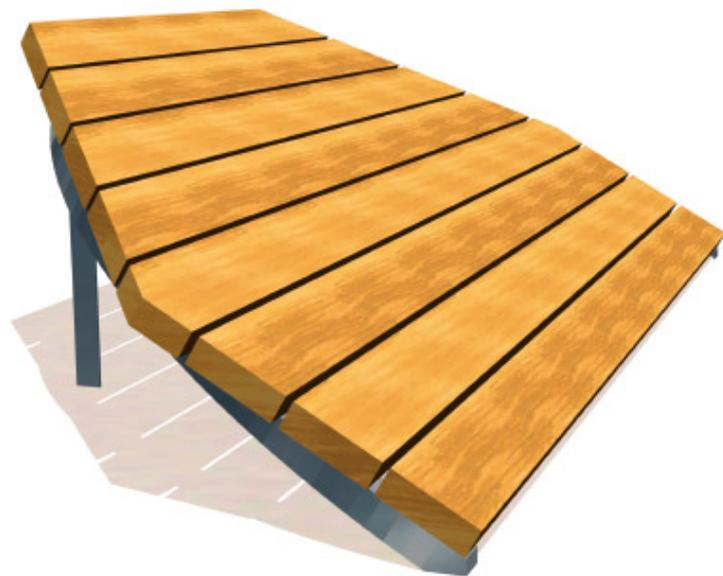
Caractéristiques techniques : Structures mécano-soudées en acier galvanisé. La visserie et les accessoires de fixations sont en acier inoxydable, protégés par des capsules anti-vandalisme. Surface de roulement en bois massif (planche 145x46 mm et/ou demi rondins Ø 140 mm) traité autoclave.
