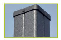
1- Les poteaux carrés 95 x 95 mm sont en acier galvanisé peint, garantissant la longévité et la robustesse dans le temps. Ils sont recouverts d'un chapeau en polyamide chargé qui est riveté sur le poteau.
