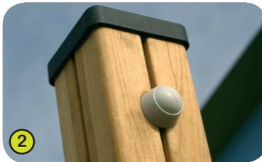
2- **Les poteaux carrés de 95 mm** sont en pin lamellé-collé traité sans chrome ni arsenic. Exempt d'échardes, le lamellé-collé assure une grande solidité et une stabilité dimensionnelle. Les poteaux sont protégés contre les attaques de champignons, d'insectes et de termites.
