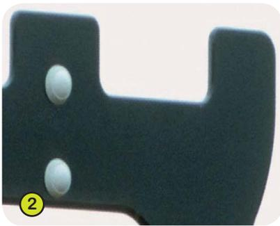
2- **Les plaques laquées** sont élaborées à partir d'un contreplaqué de 22 mm de très haute qualité composé de plis minces en bouleau. La mise en couleur est réalisée par pulvérisation de laque polyuréthane sans plomb en 3 couches dont une couche de finition vernie. Les chants sont protégés par plusieurs couches d'apprêt polyuréthane souple.
