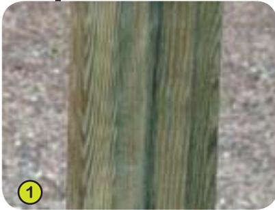
1- **Les poteaux du Pont-levis**, 68\*68 mm, sont en pin lamellé-collé, traité sans chrome ni arsenic. Exempt d'échardes, le lamellé-collé assure une grande solidité et une stabilité dimensionnelle.
