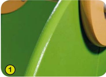
1- **Les plaques laquées** sont élaborées à partir d'un contreplaqué de 22 mm de très haute qualité composé de plis minces en bouleau. La mise en couleurs, réalisée par pulvérisation électrostratigique de laque polyuréthane bicomposant exempte de métaux lourds, assure une haute capacité de résistance aux agresseurs chimiques potentiels comme, par exemple, les produits d'entretien anti-graffiti.
