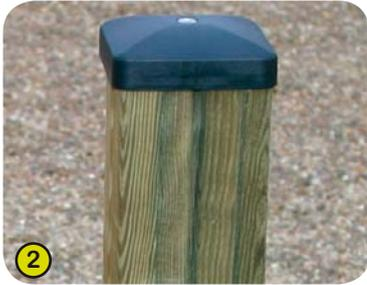
2- **Les poteaux de la grande cabane et de la plate-forme** sont en pin lamellé-collé, 68 x 68 mm, traité sans chrome ni arsenic. Exempt d'échardes, le lamellé-collé assure une grande solidité et une stabilité dimensionnelle. Les poteaux sont protégés contre les attaques de champignons, d'insectes et de termites.
