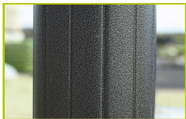
1- **Les poteaux** d'un diamètre de 125 mm sont en acier galvanisé laqué. La finition granitée en deux tons de gris présente de légers reliefs et confère une meilleure résistance aux rayures.
