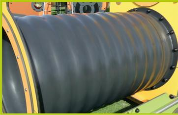
**9- Le tunnel** est en polyéthylène rotomoulé, diamètre 76 cm.
