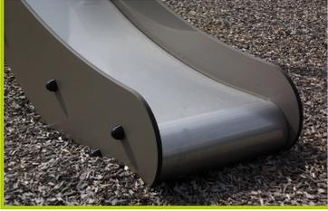
**8- La glissière** est en acier inoxydable de 2 mm d'épaisseur, cintré, plié et roulé d'une même pièce.
